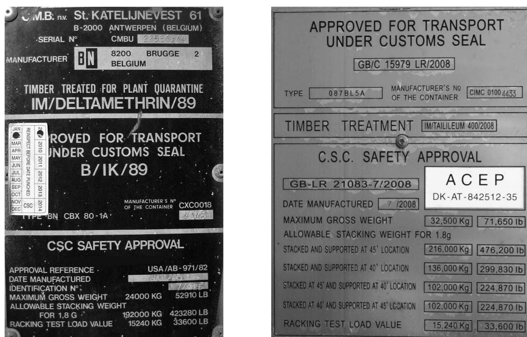
Rys. 1. Tabliczka CSC kontenerów: 20-stopowego podlegającego inspekcjom okresowym (po lewej) i 45-stopowego podlegającego inspekcjom ciągłym ACEP
