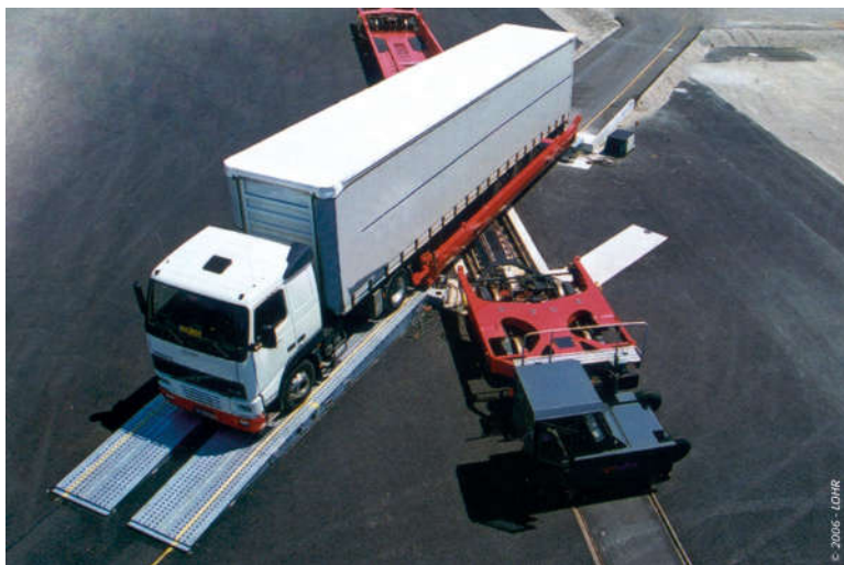
Rysunek. 2. Proces załadunku naczepy siodłowej na wagon w technologii „Modalohr”
