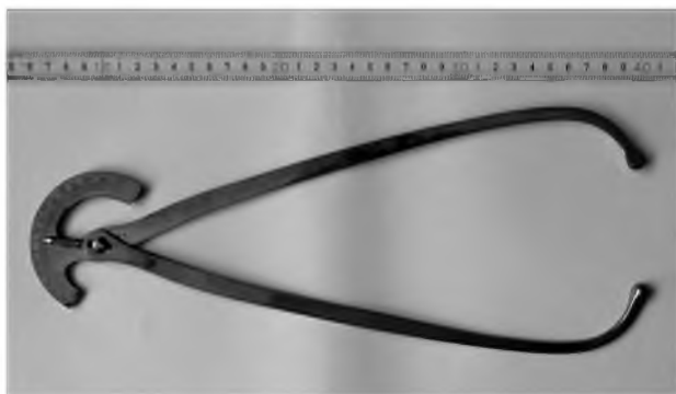
FOT. 4. Przyrząd do pomiarów ciała ludzkiego, wytw. ESCULA P A. Roszak przed 1918 zewnętrznie do 50 cm, wewnętrznie do 25 cm
